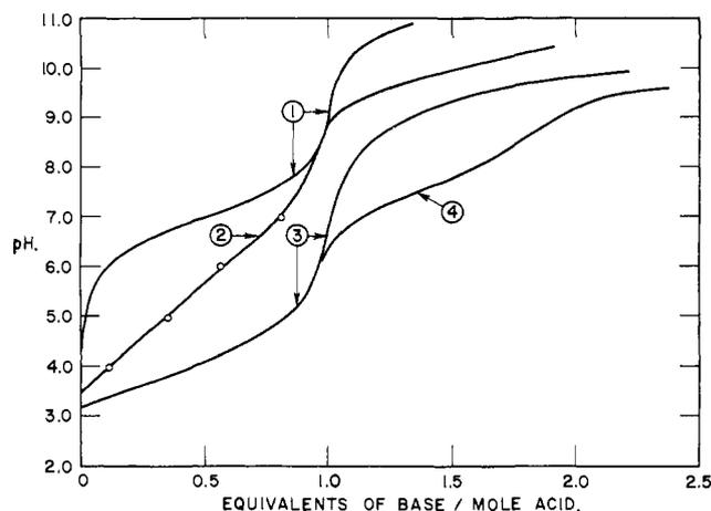
Fig. 2.—Titration curves of (1)  $H_3Cy$ , (2)  $H_2ClCy$ , (3)  $HCl_2Cy$ , and (4)  $Cl_3Cy$ ; circles calculated, see text.
